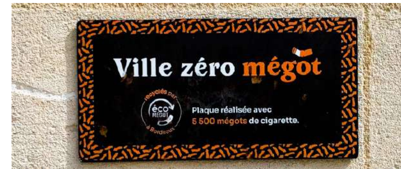
Plaque de sensibilisation obtenue après séparation et tri, broyage et dépollution et thermo-compression
