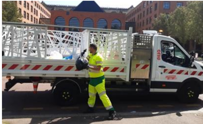
Camion plateau conduite à droite et avec 2 compartiments ajustables
